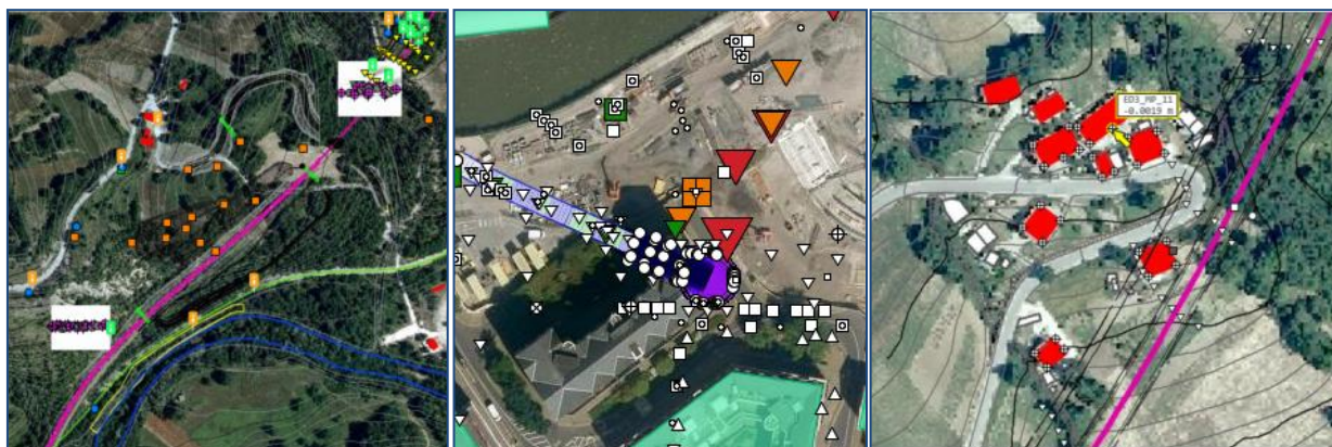
Rappresentazioni degli strumenti in pianta. Simboli e colori distinti per: sinistra - tipologia strumentale; centro - stato di allarme AAA (verde, arancio, rosso); destra - etichette con ID strumento e ultima misura.
