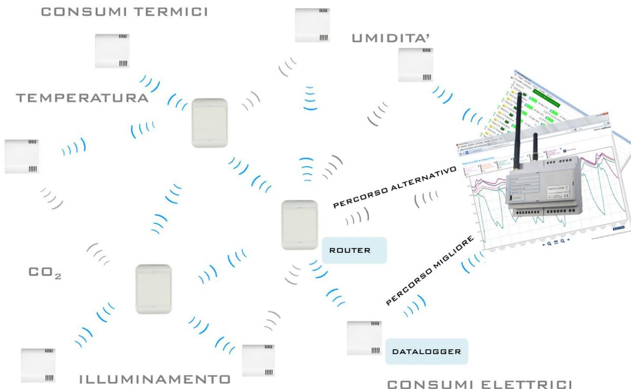
Le versioni MWDG-ETH e MWDG-WIFI permettono di utilizzare le reti esistenti attraverso l'opzione di interfacciamento Ethernet o Wi-Fi per l'invio di dati in Internet. Entrambe le versioni consentono il download dei dati sul Centro Servizi e l'accesso ai registri MODBUS PLC utilizzando il protocollo MODBUS RTU over TCP (*virtual com port*).
