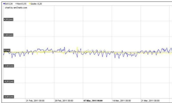
**Figura 2** – Grafico delle variazioni plano-altimetriche misurate in corrispondenza del punto 7A durante in monitoraggio in fase di spinta del Monolite Sud.
