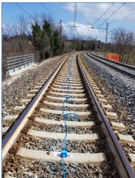
Clinometri collegati in serie sulle traversine di una linea ferroviaria
